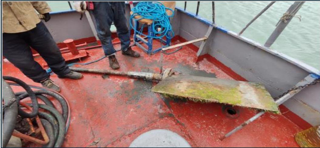
Şəkil 7: Orion-15 Təmir üçün sökülmüş sükan qurğusu.
