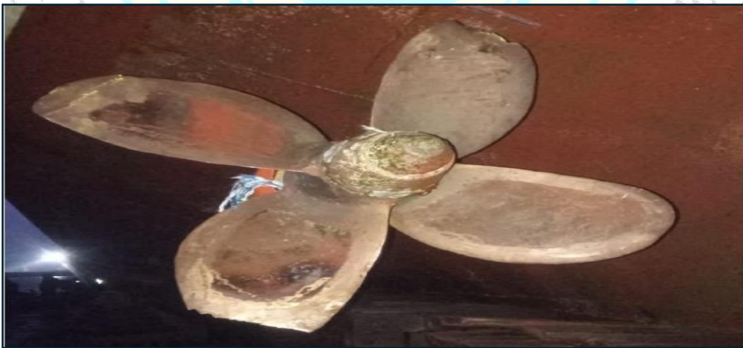
Şəkil 2 PS 173 avar vintinin zədəli vəziyyəti
